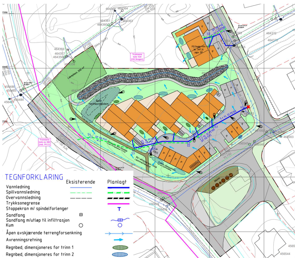
FIGUR 7 PLANLAGTE OVERVANNSTILTAK, UTKLIPP FRA TEGNING GH01 (VEDLEGG 1)
