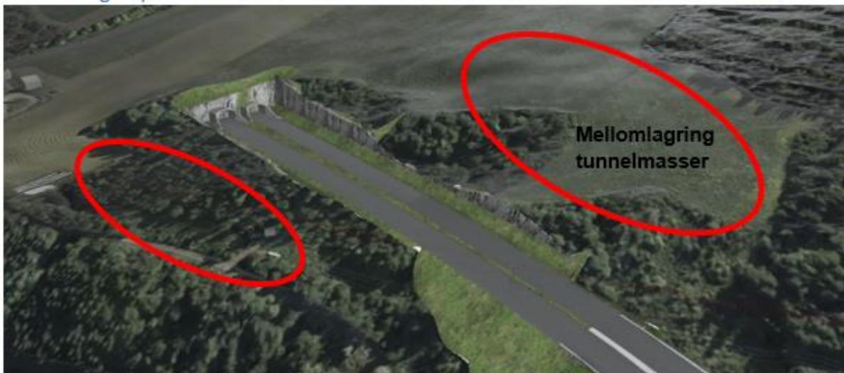
Figur 6 Illustrasjonsbilde av mulighet for mellomlagring av tunnelmasser ved KDP løsning for Vingnestunnelen og KDP Kryssløsning Lågen
