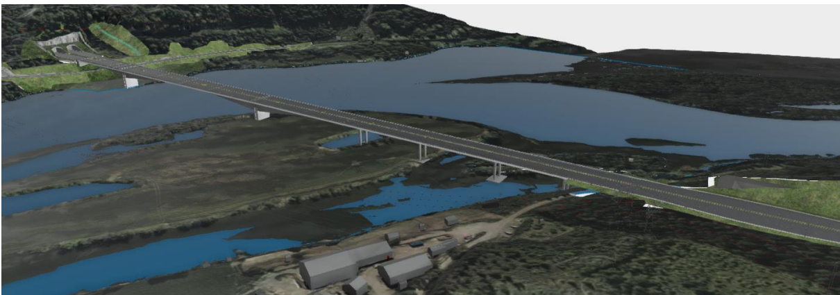
Figur 2-14. Lågen bru i justert linje, fritt frembygg-bru
