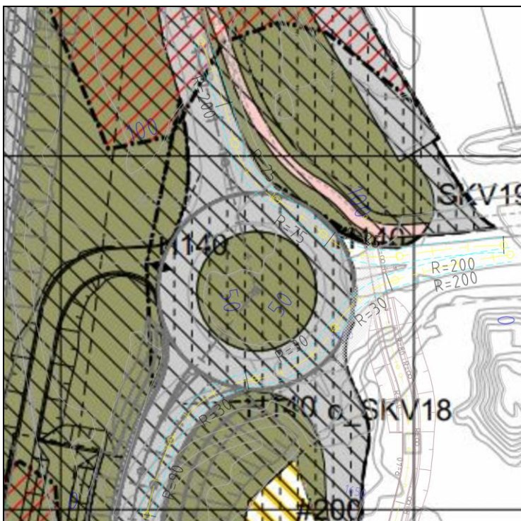
Figur 7 Kontroll av avbøyning i regulert situasjon
