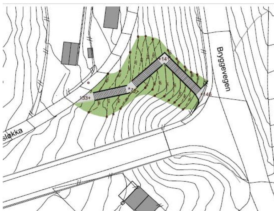
Figur 5-19: Trapp i enden av Vingnesbrua
