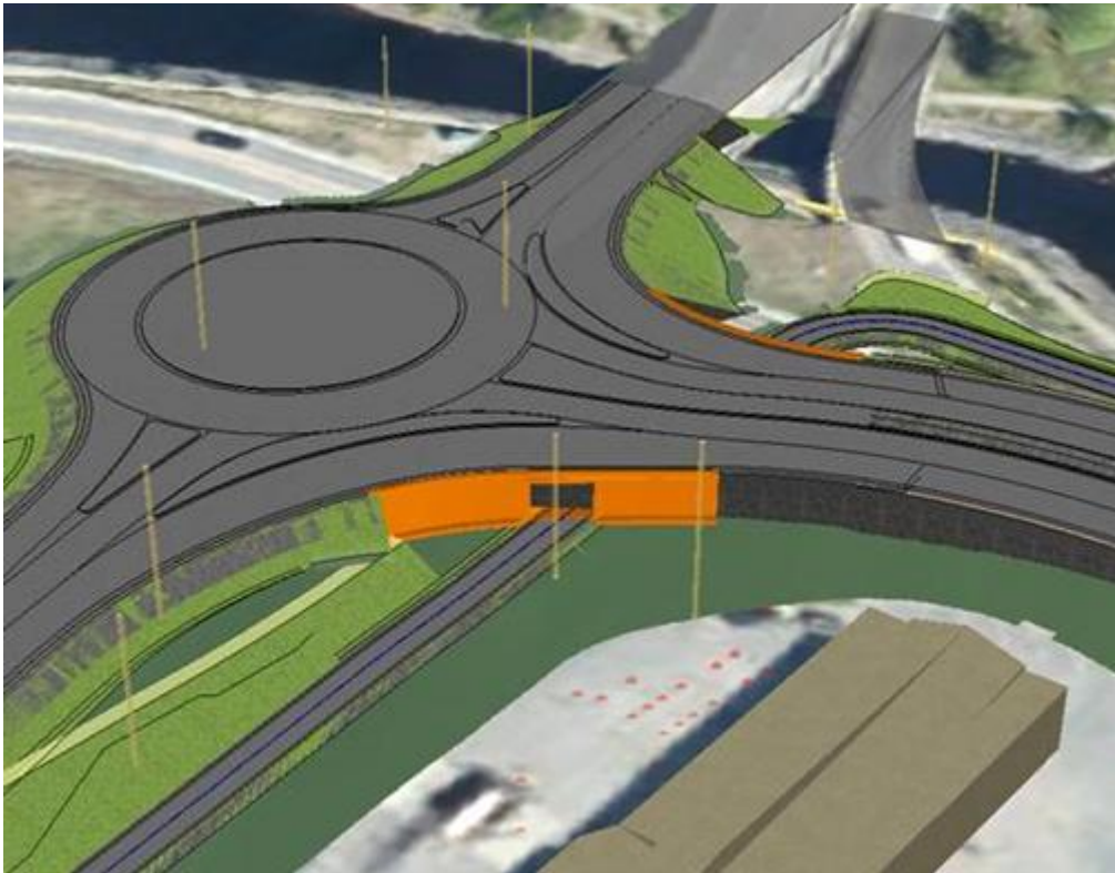
Figur 5-29: 3D modell av kulvert sett fra sør
