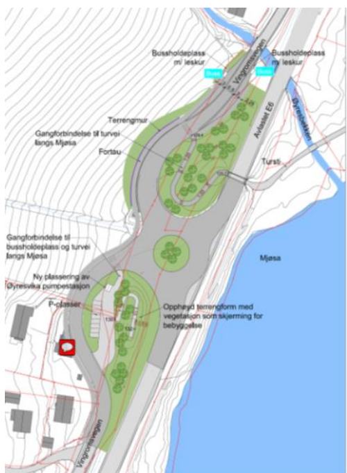
Figur 7 Kryssløsning Øyresvika som rundkjøring (2D)
